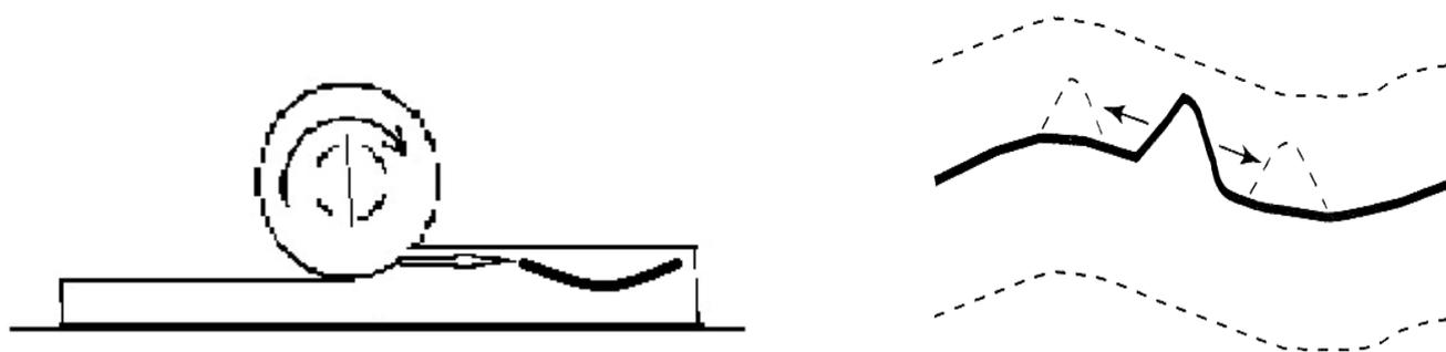
Рисунок 7 – Имитационная модель продавливания макромолекул внутри структурных трубок вязкоупругой системы при сдвиговых деформациях.
