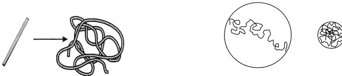
Рисунок 2 – Имитационное моделирование реакции линейных цепей высокомолекулярного строения в клубок и глобулу от внешнего химического или температурного воздействия
