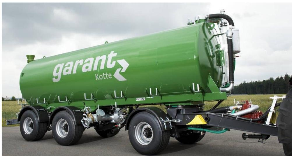
Рисунок 7 - ВТА 20 / ВТА 23 Гарант прицепные 3-х осные транспортные цистерны для перевозки жидких удобрений и ядохимикатов
