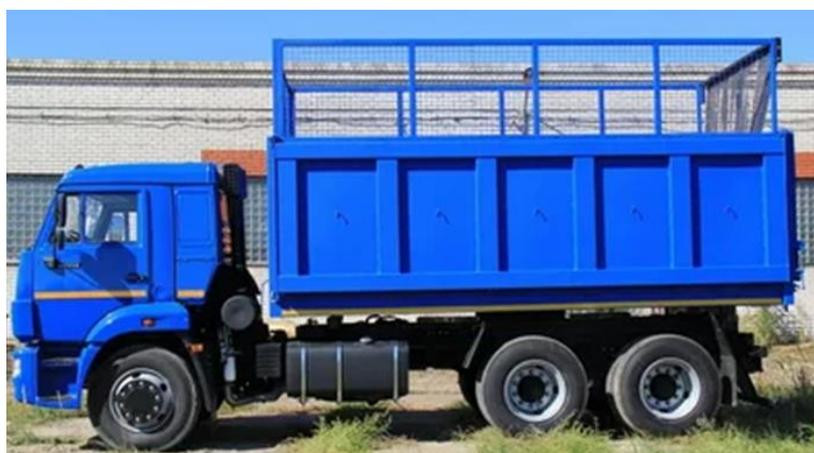
Рисунок 1 - Автомобиль-самосвал КАМАЗ-4528-01
