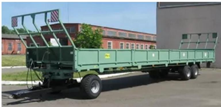
Рисунок 3 - Платформа для транспортировки кормов (ПТК-10)
