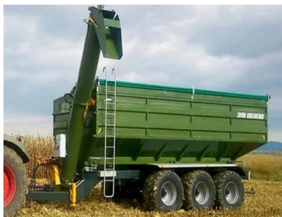
Рисунок 4 – Перегрузчик зерна
