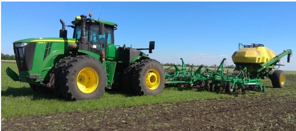
Рисунок 1 – Культиватора для внесения удобрений КВУ-8,8 с туковым бункером «John Deere 1910» в агрегате с трактором «John Deere 9420R» в работе (вид спереди сбоку)
