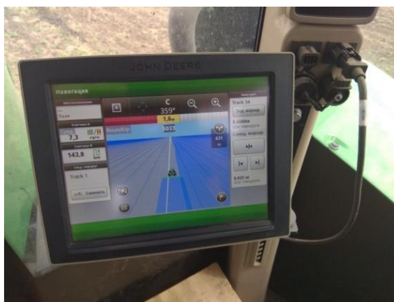
Рисунок 2 – Дисплей системы GPS навигации и автоматического управления «CommandCenter™ GS 4 поколения» (AutoTrac)
