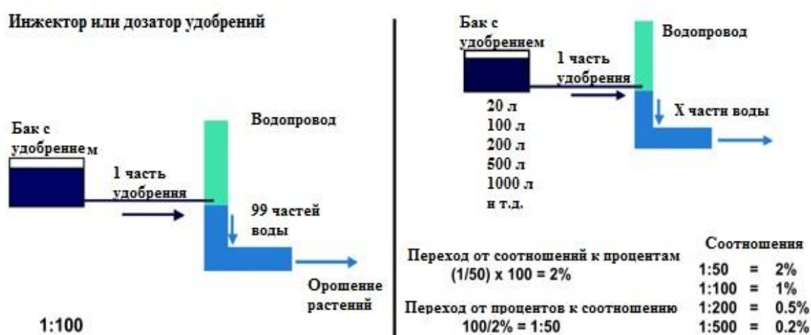
Рисунок 1 принципы работы инжекторов
