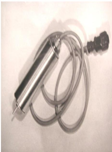
Рисунок 6 - Магнитодинамический преобразователь
