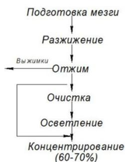
Рисунок 2 – схема производства диффузионного сока
