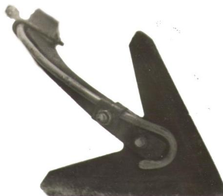
**Рисунок 3.** Рабочий орган культиватора КПС-4М. с одной подкормочной трубкой
