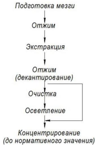
Рисунок 3 – предлагаемая технология производства соков
