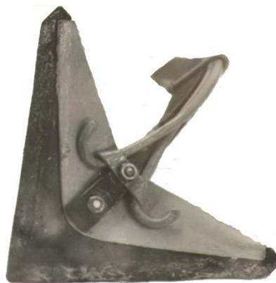
**Рисунок 5 .** Рабочий орган культиватора КПС-4М. с двумя подкормочными трубками
