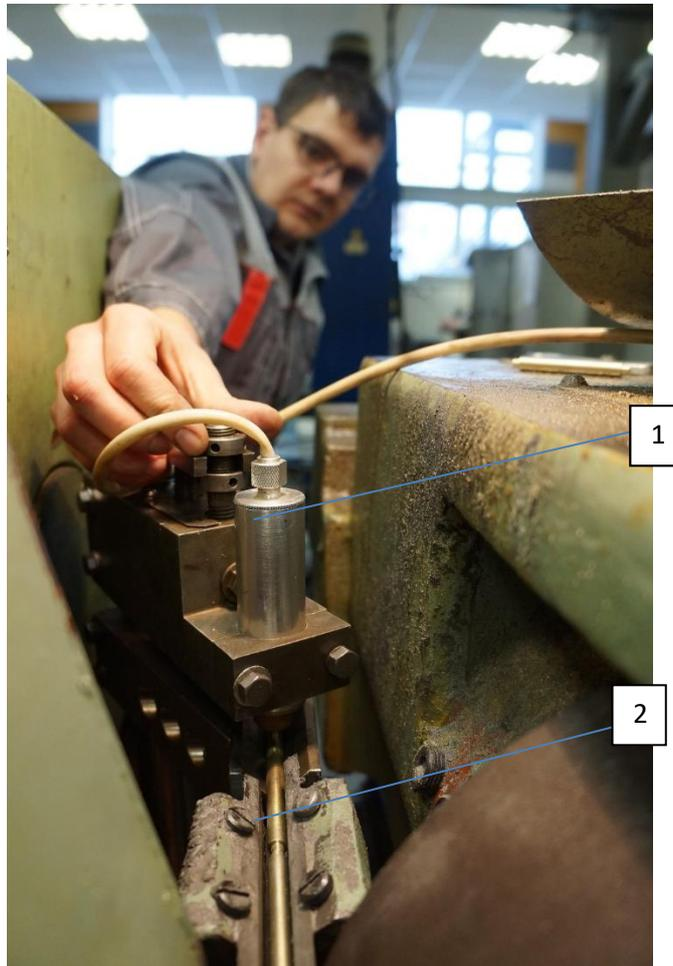
Рис.1. Настройка положения первичного измерительного преобразователя (1) по образцовым деталям (2)
